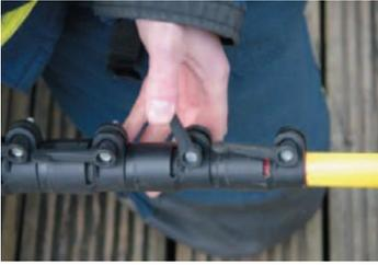
1 :ポールの先端方向へレバーを起こしてロックを解除します、付属のスローバックより充分なロープの長さを出しておきます。シャフトを引き出し伸ばします、レバーを戻せばロックが掛かります。シャフトが固定され回らないか確認して下さい
