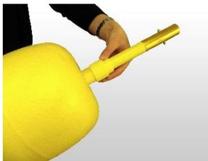
クランピングフロートの青色印よりポールに差し込み上部黄色つまみを回して締め付けます。
