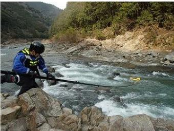
4 :伸ばす程、テコの作用で浮力ボールの重みが発生しますので、対象物まで到達させるために水面に付けて水面を滑らせます。流れに対してもテコの作用が発生しますので、流れにそって滑らせます。
