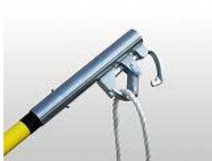
カルゴは遠い離れた箇所へカラビナを結着させる装備です。上方向、下方向問わずにハーネス、支点にカラビナを決着させる事ができます。カラビナにロープを結着しゲートを開けた状態でアタッチメントを取り付けます。目標物にカラビナを掛けポールを引き離せばカラビナを取り付ける事ができます。
